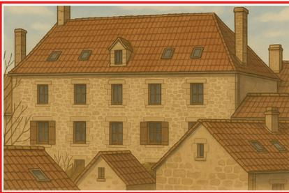
Les lucarnes sont conservées dans leurs formes ou créées dans le modèle traditionnel. Les fenêtres de toit de petite taille sont autorisées - dimensions 55 x 78 cm et meneau patrimoine. Les souches de cheminées anciennes en maçonnerie sont conservées et restaurées. En toiture, les équipements solaires sont soumis à autorisation.
